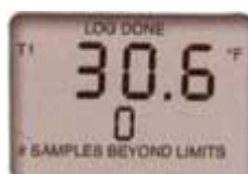
Aantal meetpunten welke het hoog of laag alarm hebben overschreden
